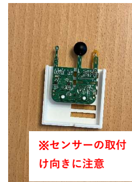
⑤センサーにUSBケーブル取付け (ケースは突起がある側が正面)
